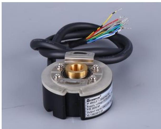
编码器电源的选择：选择具有宽工作电源与信号短路保护的编码器，很多的编码器干扰来自于其供电电源的波动，和电源0V基准的破坏。要避免此类干扰情况的出现，现场的编码器应由特定的工作电源单独供电，并且在输出功率选择上需做到足够大（编码器标示功耗的2倍以上）；同时，选择的编码器应具有宽工作电压，例
